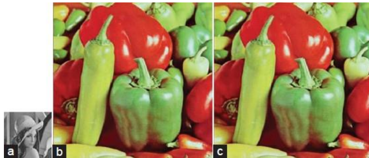
Figure 5 : exemple de stéganographie (Crédit : Atawneh, Almomani et Sumari). L'image (a) est le message à cacher. L'image (b) est l'image dans laquelle le message sera caché. L'image (c) est le résultat de cette stéganographie avec la méthode LSB 18 . Constatation : il n'y a aucune différence remarquable à l'œil nu entre l'image (b) et l'image (c).
